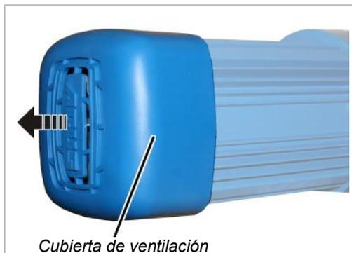
→ Extraer la cubierta de ventilación.
