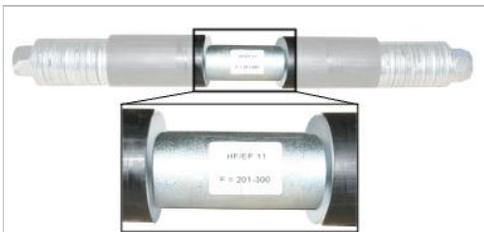
➔ Compare si el ancho de brida F de la viga I se encuentra dentro del ámbito de tolerancia indicado en el bulón del mecanismo de traslación.
