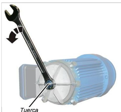
→ Sujete la aleta del ventilador y apriete la tuerca autoblocante con fuerza manual. La aleta del ventilador ya no se debe poder dejar girar.
